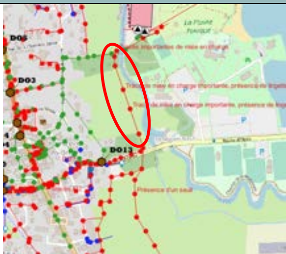
FIGURE 30 – ZONE DE DEBOREMENTS A L'AVAL DE LA ROUTE D'ETREZ
